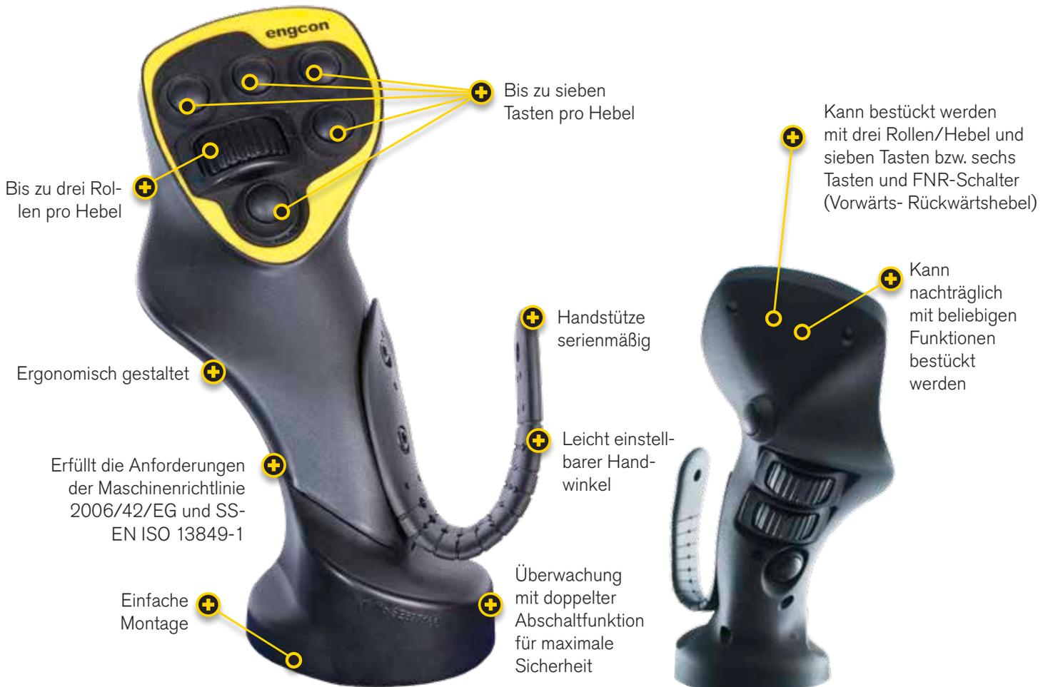
Der engcon-Baggerjoystick vereint in sich maximale Ergonomie und Funktionalität. Der Joystick erfüllt die erhöhten Sicherheitsanforderungen und verfügt über zusätzliche Steuerfunktionen.
